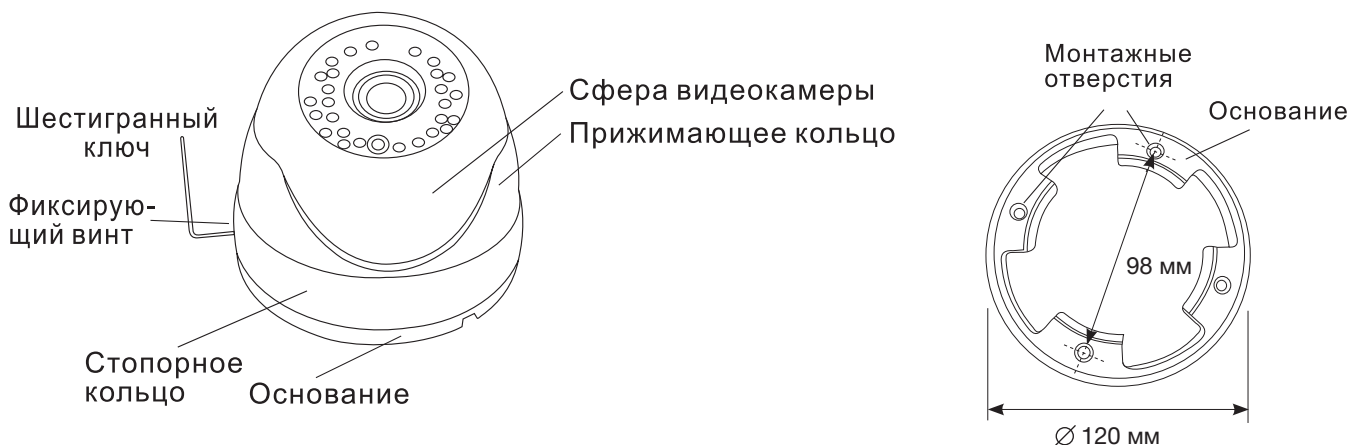
Рис.2.7 Схематическое изображение камеры.
